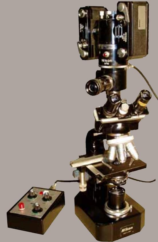
Este microscopio lleva, sobre el trinocular, un tubo que soporta todo el sistema fotográfico. En este sistema se encuentra un ocular para realizar el enfoque correcto, el mecanismo de disparo y dos cámaras fotográficas de 35 mm, generalmente, una para carrete en blanco y negro y otra para color.
